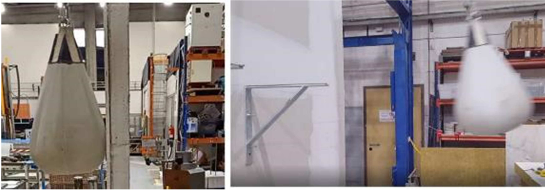
Ensayo de resistencia a impactos de cuerpo blando. Lanzamiento de un saco esferocónico de 50kg contra el tabique liberando una energía de 400J.
