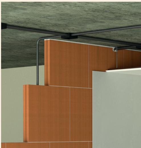
**Figura 3.-** MURALIT Sin Rozas. Colocación de las instalaciones en una obra CON falso techo
