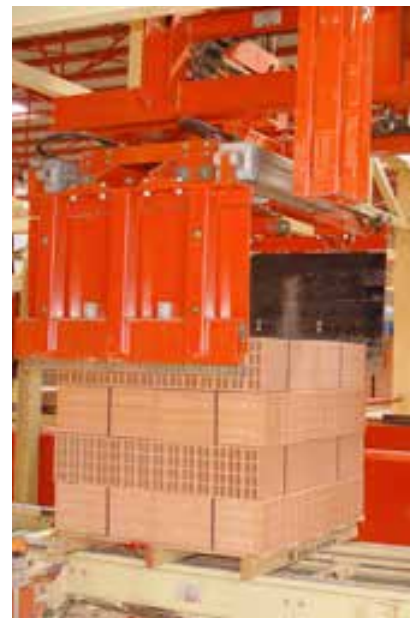
DEHACKING ON PALLET | DESAPILADO SOBRE PALET DÉPILAGE SUR PALETTE
