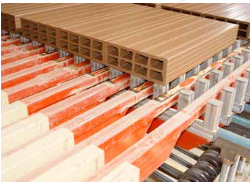
BELT AND BOLT SYSTEM | SISTEMA DE CORREAS Y TACOS | SYSTÈME À COURROIES ET TASSEAUX
