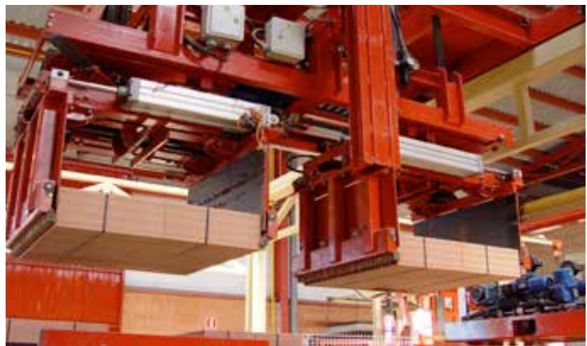
DEHACKING GRIPPERS | PINZAS DE DESAPILADO | PINCES DÉPILAGE
