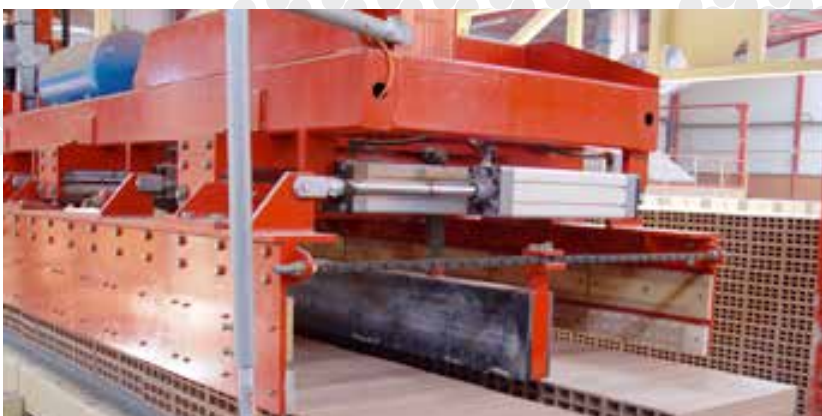
SETTING GRIPPER CLOSE VIEW | DETALLE PINZA APILADO | DÉTAIL PINCE EMPILAGE
