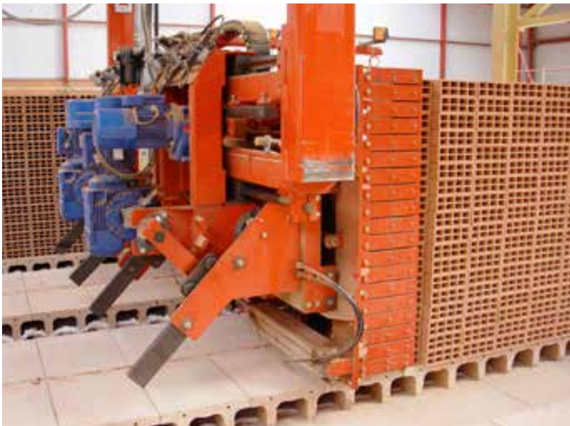
DEHACKING GRIPPER WITH TURNING-OVER MOVEMENT | PINZA DESCARGA CON VOLTEO | PINCE DÉCHARGEMENT AVEC CULBUTAGE
