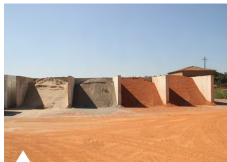
Acopio y clasificación de arcillas procedentes de la cantera.
