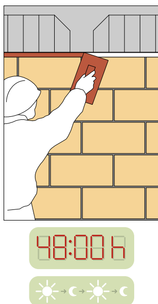
Figura 34. Recibido de la fábrica al forjado superior transcurridas 48 horas del montaje de la fábrica.
